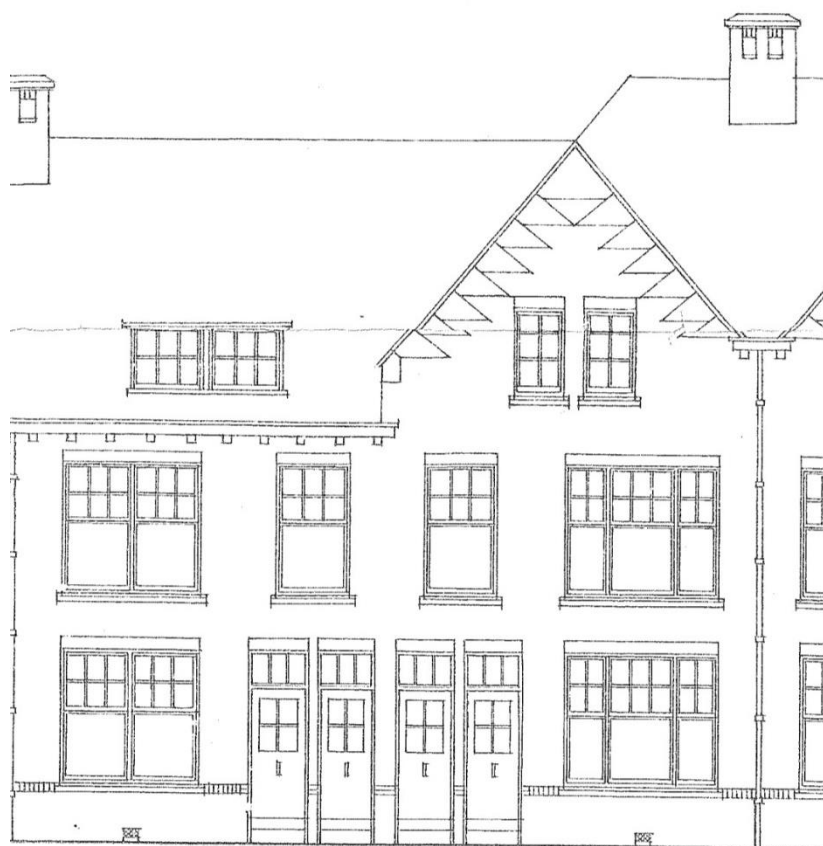
oorspronkelijke verfijning in de variatie van het kozijndetail
